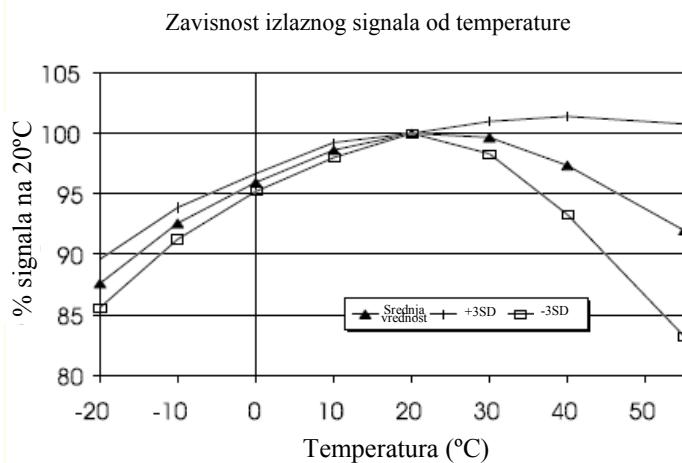
**Uticaj temperature:** Izlazni signal iz detektora može da varira u zavisnosti od temeperature. Ova zavisnost je utvrđena eksperimentalnim putem, testirajući 16 senzora. Rezultati su prikazani na grafiku pomoću srednje vrednosti, i izraženi su u procentima pri čemu je referentna vrednost (100%) uzet signal na temperaturi od 20°C.
